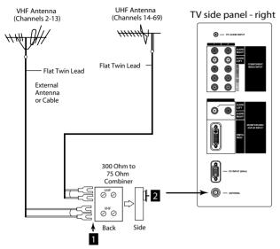
Figure 1. Connecting separate UHF and VHF antennas.
